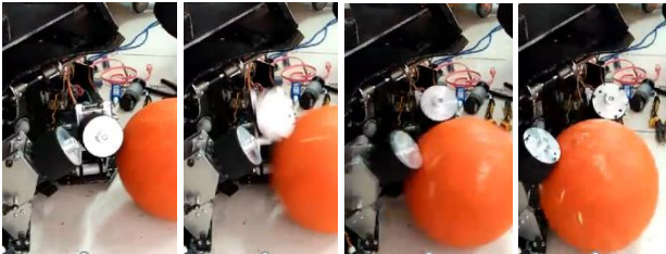
Gambar 9. Kecenderungan bola untuk bergulir ke dalam penggiring
